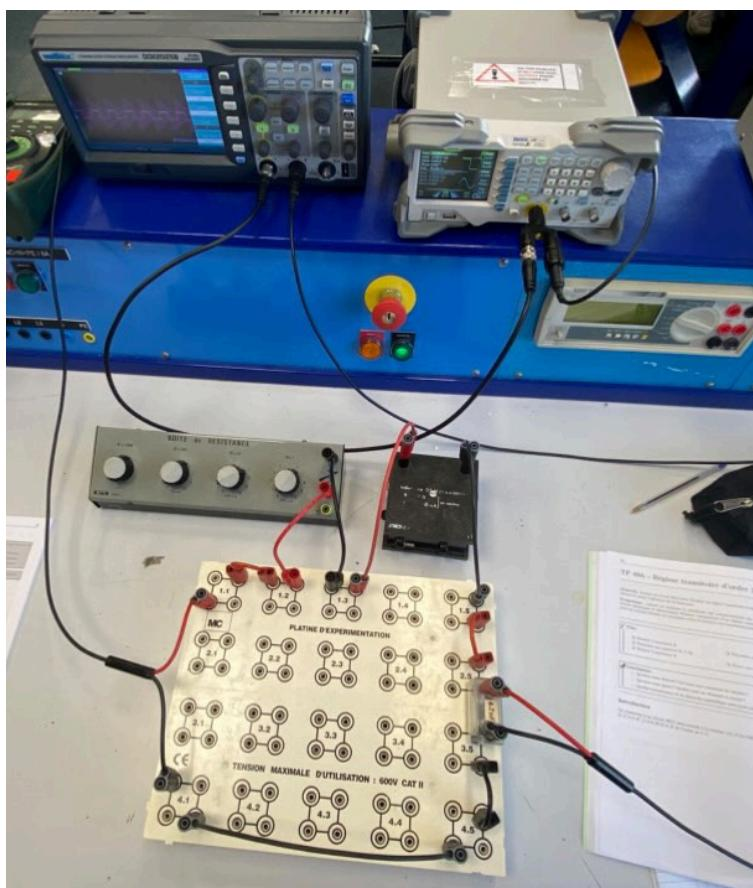
Sur ce montage, un oscilloscope est monté en dérivation aux bornes de C, et du GBF, afin de vérifier  $e(t)$  et d'observer la tension  $U_c$ .
